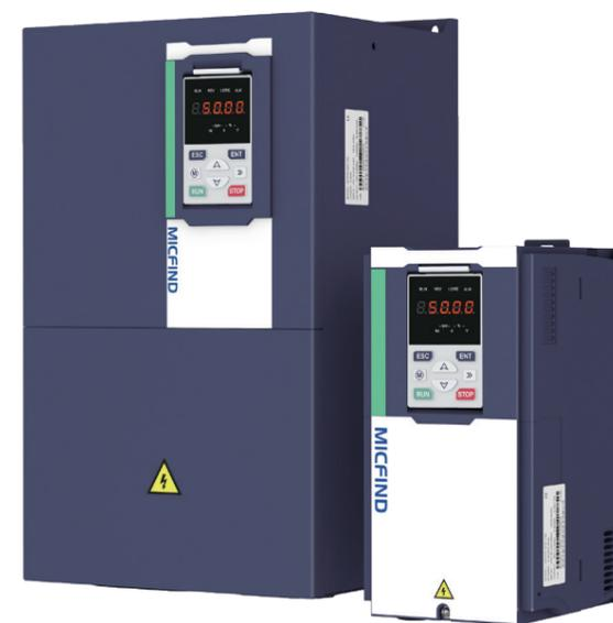
MT530系列矢量变频器既可以驱动异步电机，也可以驱动永磁同步电机。产品具有优异的软件性能，支持无编码器矢量控制以及闭环矢量控制，无编码器矢量控制下转矩精度可达5%，在大部分转矩收放场合可省掉编码器反馈。产品硬件可靠性高，电磁兼容性强，接口兼容MT500的所有选配件及扩展卡。
