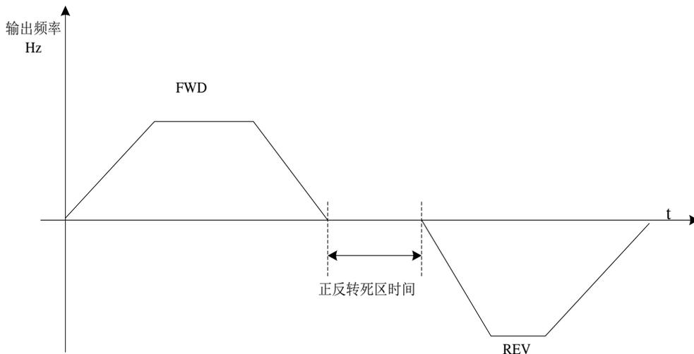
图 6-6 正反转死区时间示意图
