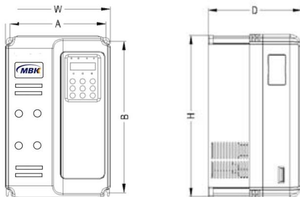
图 2-4 MBK300 系列塑件结构外型尺寸及安装尺寸示意图
