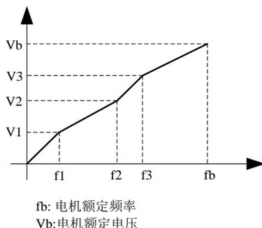
图 6-30 多点 V/F 曲线设定示意图
