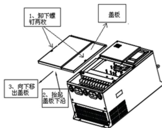
图 3-4 钣金机箱下面板的拆卸
