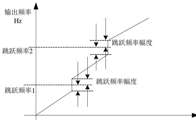
图 6-20 加减速过程中跳跃频率有效示意图
