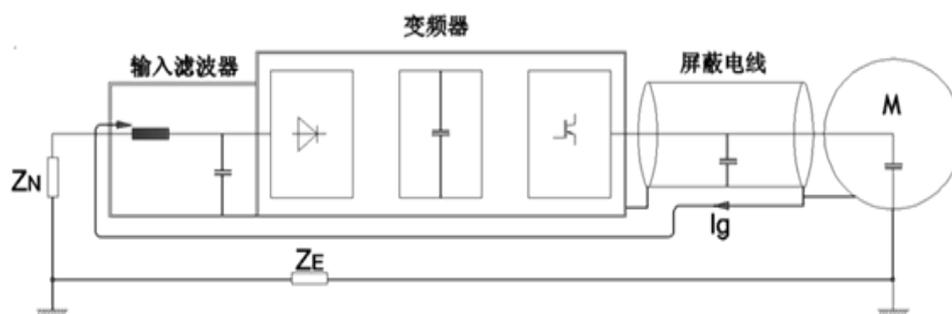
图 3-6 防传导辐射干扰接线示意图
