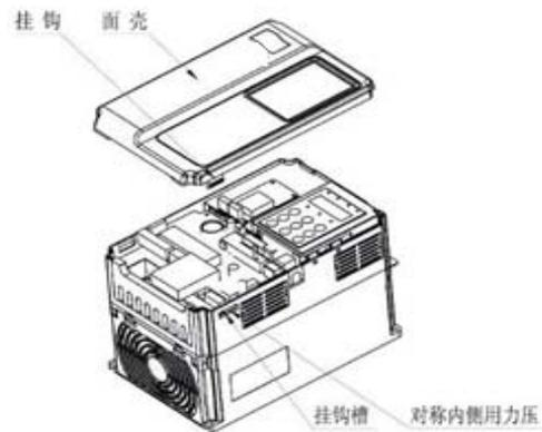
图 3-3 塑壳机箱下面板的拆卸
