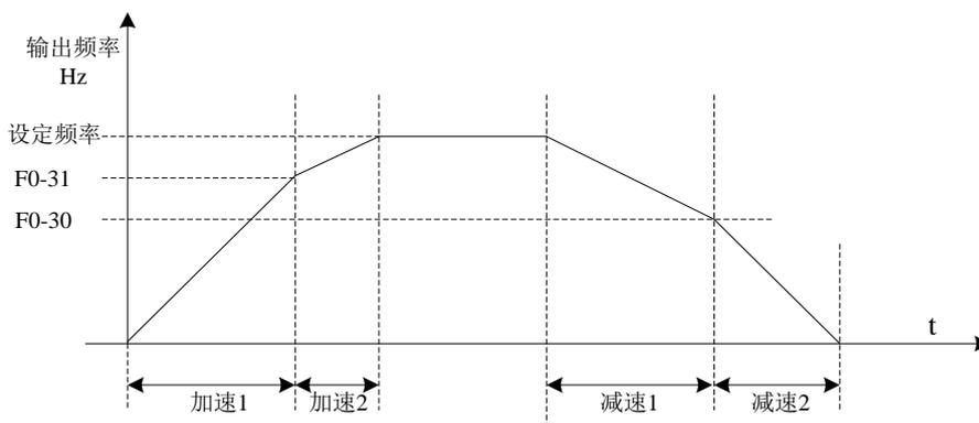
图 6-4 加减速时间切换示意图
