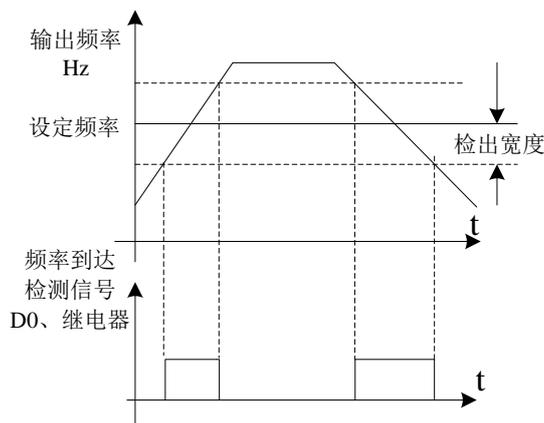
图 6-14 频率到达检出幅值示意图
