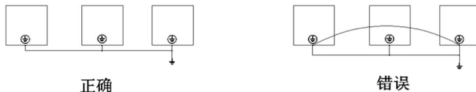
图 3-5 接地线接法示意图
