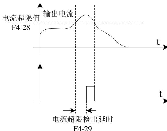
图 6-17 输出电流超限检测示意图
