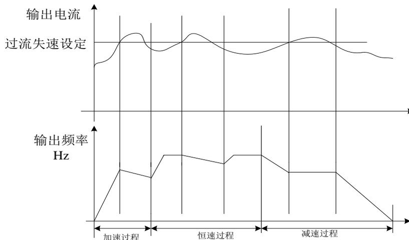
图 6-21 过流失速保护示意图
