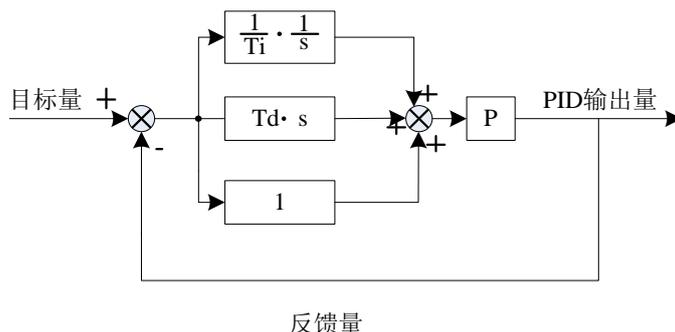
图 6-23 过程 PID 原理框图
