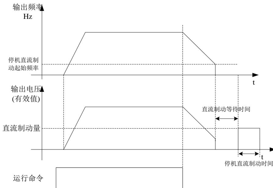
图 6-5 停机直流制动示意图
