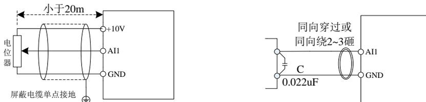
图 3-10 模拟量输入端子接线方式
