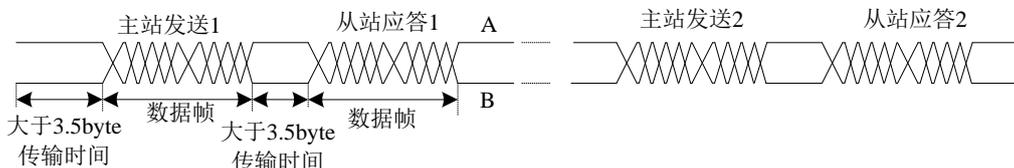
MBK300 系列变频器内置的通信协议是 Modbus-RTU 从机通信协议，可响应主机的“查询/命令”，或根据主机的“查询/命令”做出相应的动作，并通讯数据应答。
