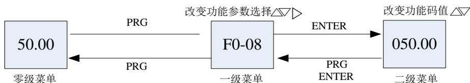
图 4-2 两级菜单操作流程图
