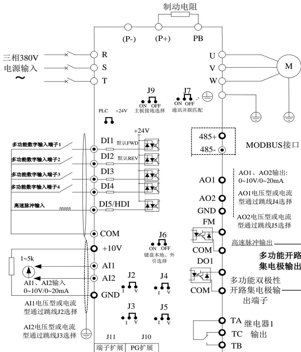
图 3-8 控制回路及主回路接线图
