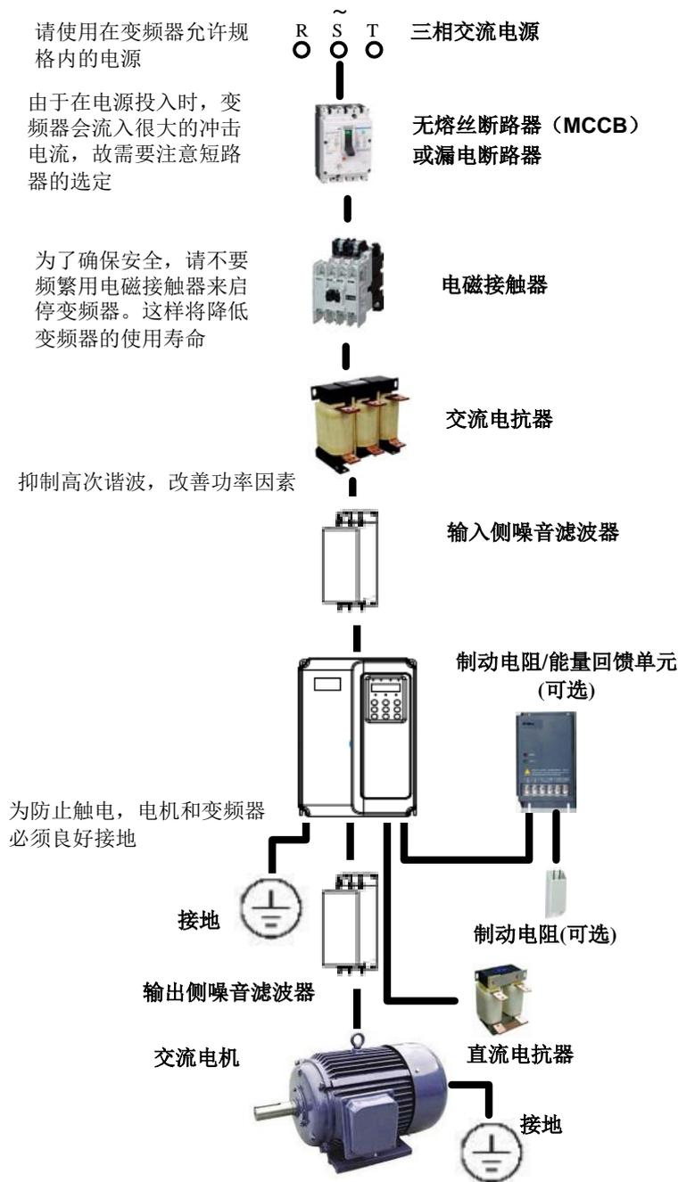
图 3-2 变频器外围设备连接图
