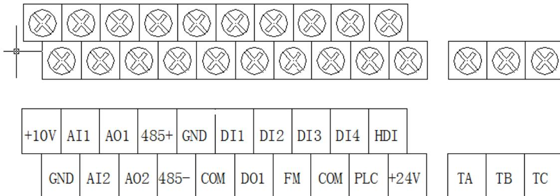
图 3-9 MBK300 控制回路端子图
