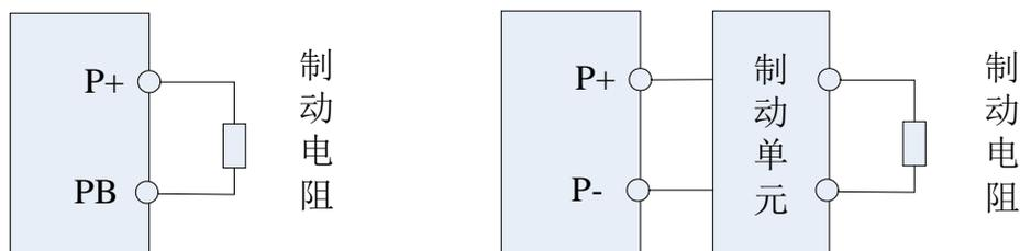
图 2-7 制动电阻连接示意图
