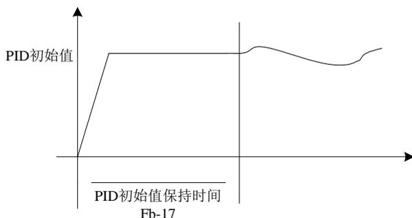
图 6-25 PID 初值功能示意图
